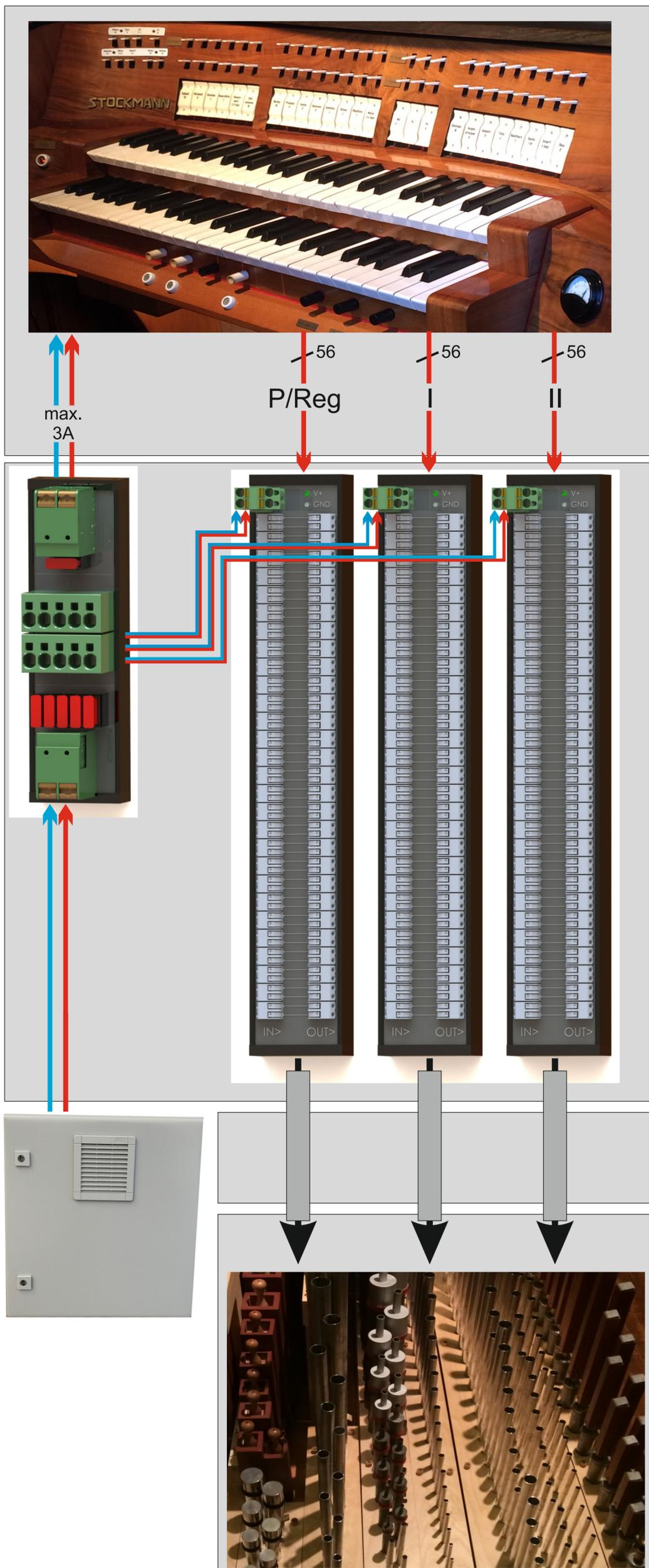
Die alte Spieltisch-Elektrik arbeitet praktisch stromlos (Absicherung 3A), da die Last der Magneten nun von den Verstärker-Karten geschaltet wird.
